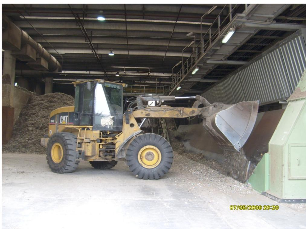
Fig. n. 1.3.4: Sistema di carico del CDR
